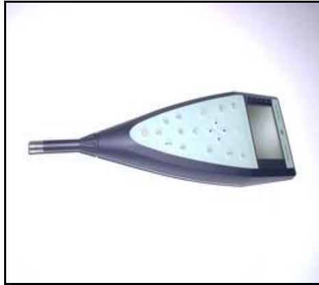
Figura D.3 – Sonómetro Brüel Kjaer 2260 – Investigator (Landscentret, 2008)
