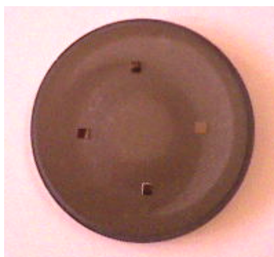
Figura 2.3 – Alvo de B 4 C com 4 pedaços de silício embutidos na zona de erosão preferencial.
