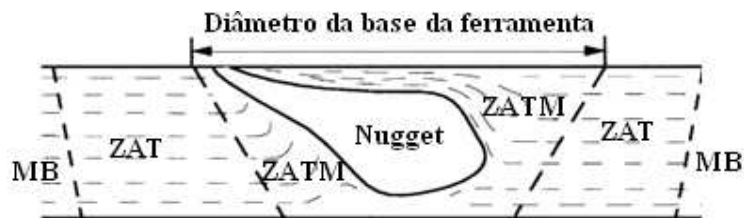
Figura 2-7 – Representação esquemática das diferentes regiões microestruturais numa soldadura por SFL.
