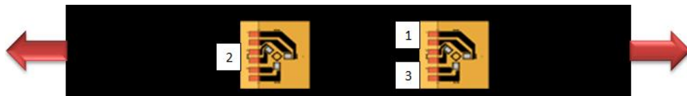
Figura 14. Exemplo da disposição do extensómetro no provete.
