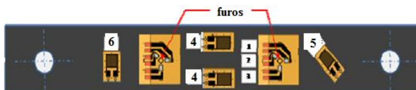
Figura 16. Provelte com extensómetros todos colados (Nobre 2010).
