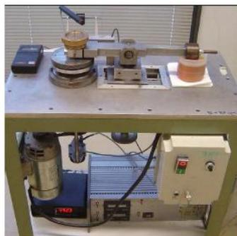
Figura 14 - Equipamento protótipo de pino-disco.
