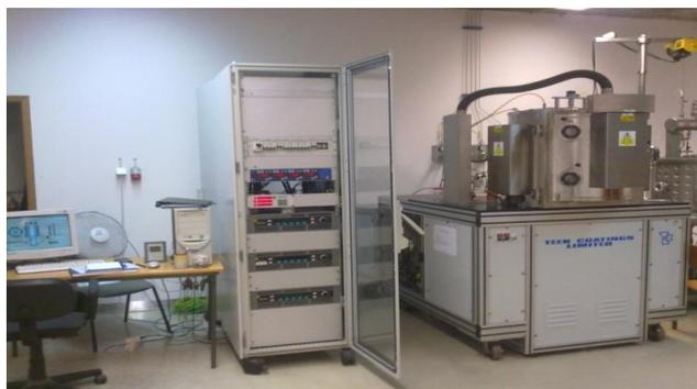
Figura 6 - Equipamento de pulverização catódica da Teer Coatings Lda.
