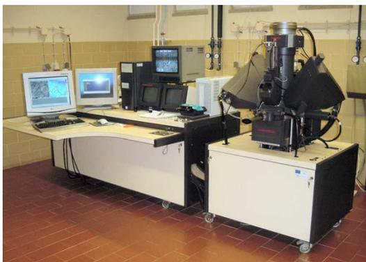
**Figura 10 - Microsonda electrónica.**
