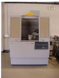
Figura 9 - Equipamento de difracção de raios X.
