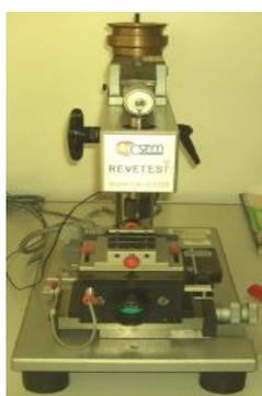
Figura 12 - Equipamento de indentação deslizante.
