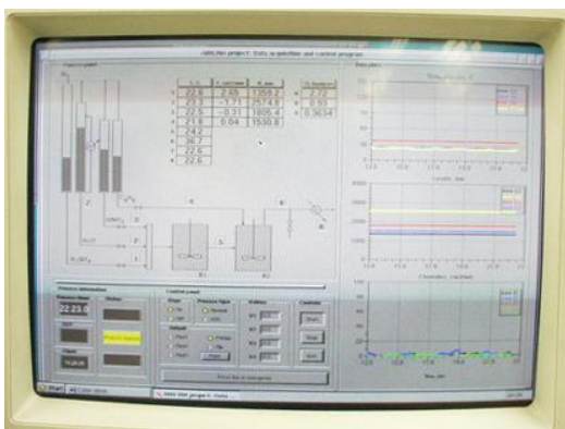
Figura 3.11. Display do programa de controlo da instalação.
