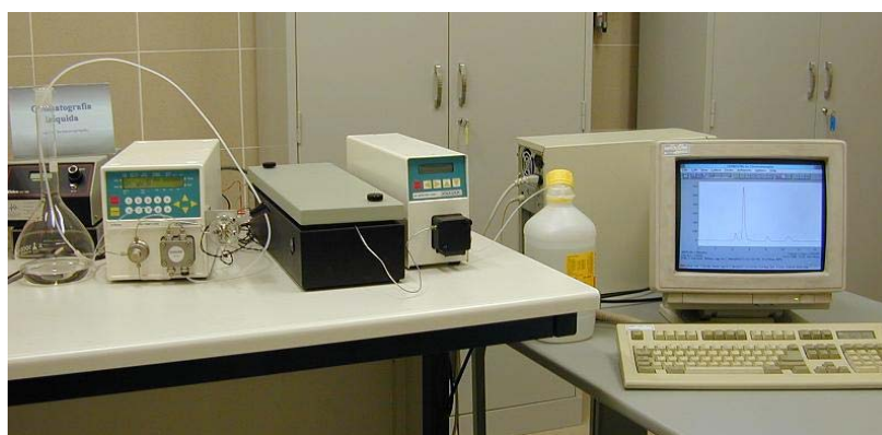
Figura 4.7. Cromatógrafo de HPLC da Knauer.
