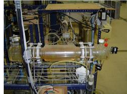
Figura 3.10. Permutador/Decantador de fases.
