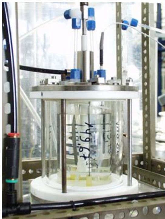
Figura 3.5. Reactor em vidro com pressurização.
