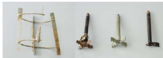
Figura 3.7. Chicanas e agitadores em aço inox com revestimento de Teflon após utilização no reactor de nitração.
