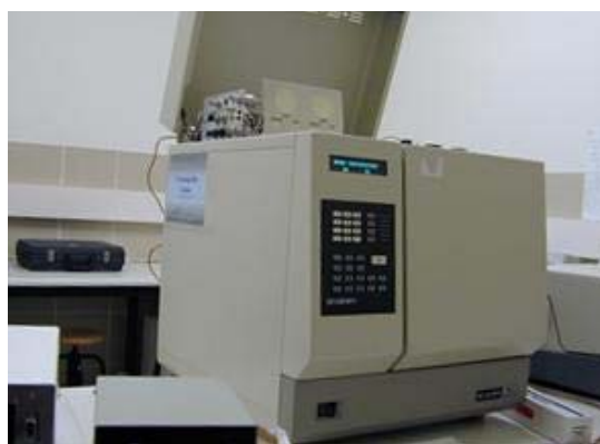
Figura 4.6. Cromatógrafo Gasoso 9001 da Tremetrics.
