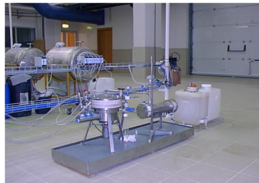
Figura 3.3. Zona de reacção e recolha de efluente.
