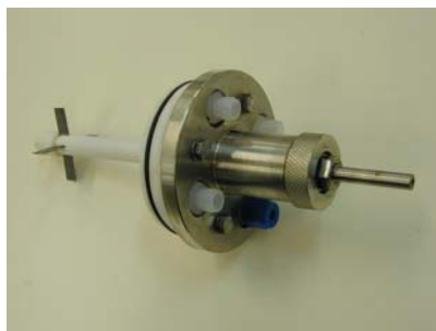
Figura 3.18. Agitador de quatro pás, empanque mecânico e sistema de selagem.
