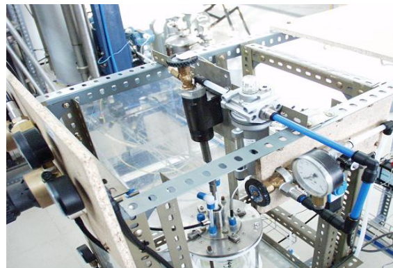
Figura 3.6. Pormenor do sistema pneumático de agitação e do topo do reactor.
