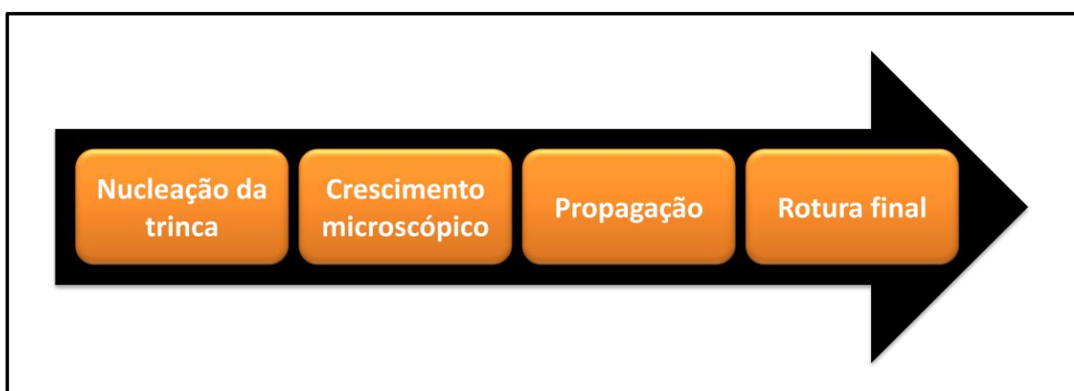
Figura 2.1 Esquema representativo dos mecanismos de fractura por fadiga.
