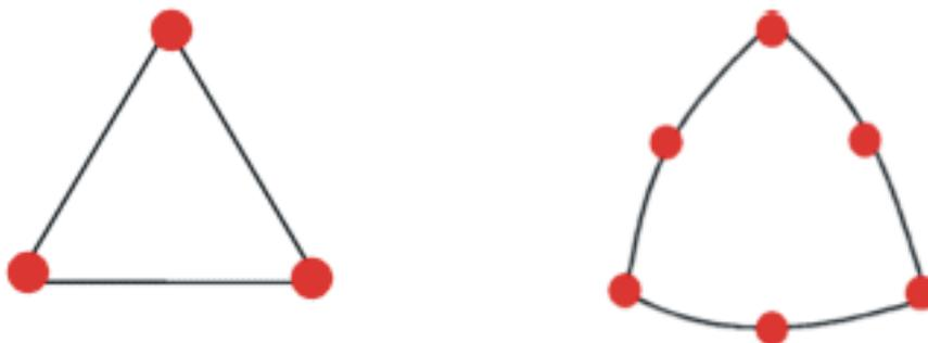
Figura 5 - Elemento triangular linear e Elemento triangular parabólico
