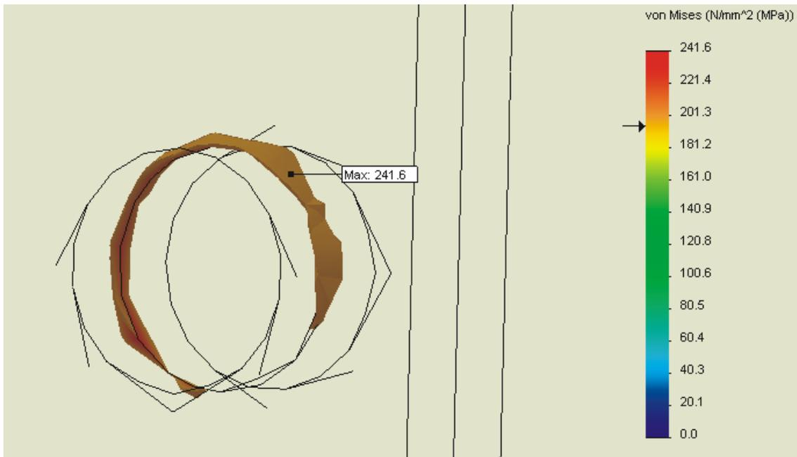
**Figura 38 – Vista em pormenor das tensões na zona do furo**
