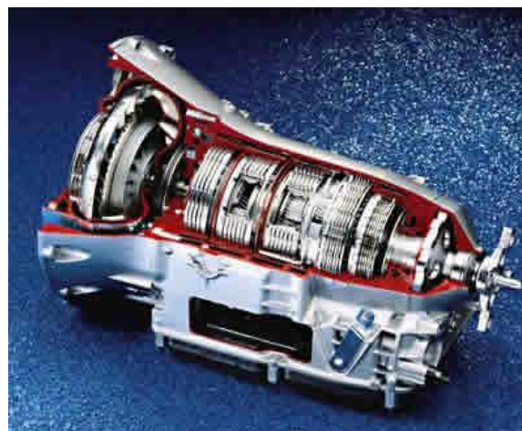
Figura 14. Foto cortesia de DaimlerChrysler Mercedes-Benz CLK - transmissão automática (modelo em corte). [15]
