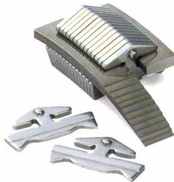
Figura 19. Correia de atrito em corte, utilizada nas caixas de velocidades CVT da Honda .
