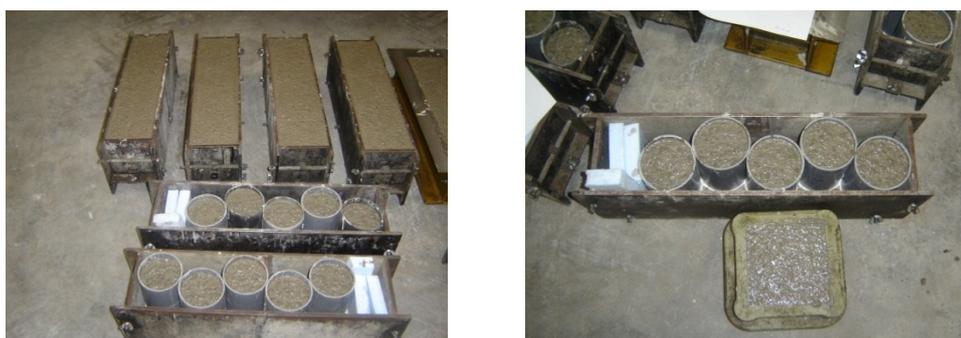
Figura 7.13 – Moldagem dos provetes.
