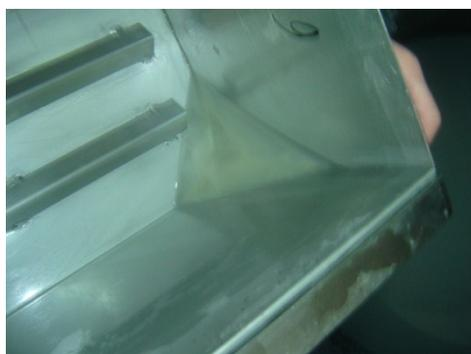
Figura 5.6 – Aspecto do material destacado após 7 ciclos de gelo-degelo.
