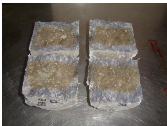
Figura 7.19 – Exemplo da visibilidade (região mais clara) da reacção dos cloretos do betão com a solução de nitrato de prata, na face superior e na face inferior dos provetes.
