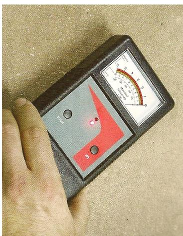
Figura 4.9 – Aparelho para realização dos testes de impedância eléctrica.
