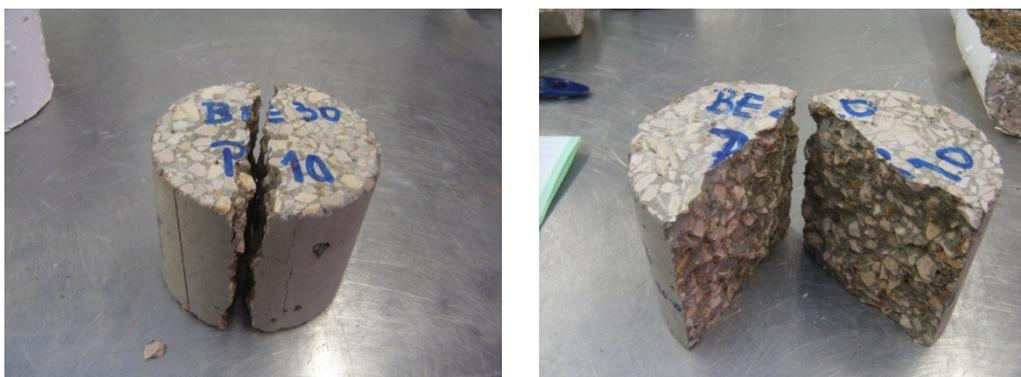
Figura 7.18 – Exemplo de um provete cilíndrico após a rotura por compressão diametral.
