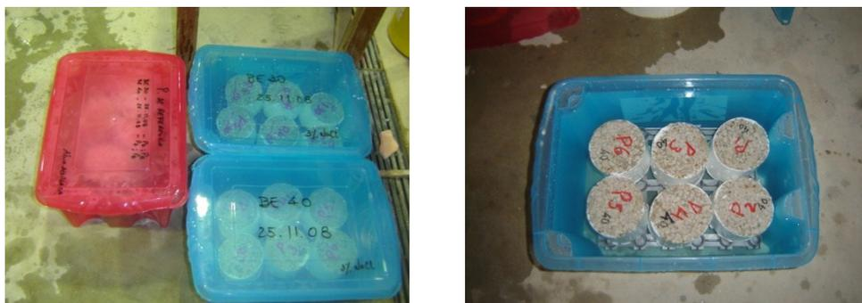
Figura 7.15 - Identificação e colocação dos provetes nas respectivas soluções.
