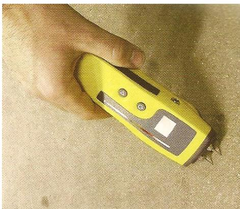
Figura 4.8 – Aparelho para realização dos testes de resistência eléctrica.
