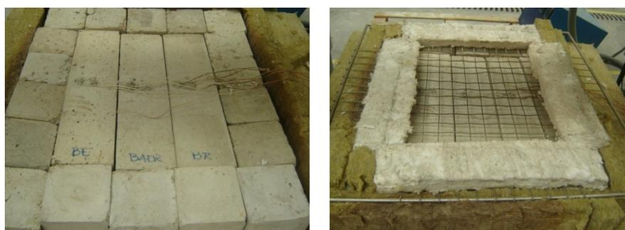
Figura 6.12 – a) Identificação e colocação dos provetes prismáticos de betão no interior do forno; b) Colocação da rede metálica de protecção e do isolamento na periferia.
