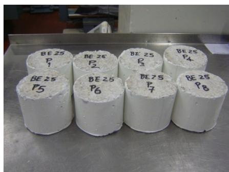
Figura 7.14 – Impermeabilização da superfície lateral dos provetes por aplicação de uma tinta epóxida.
