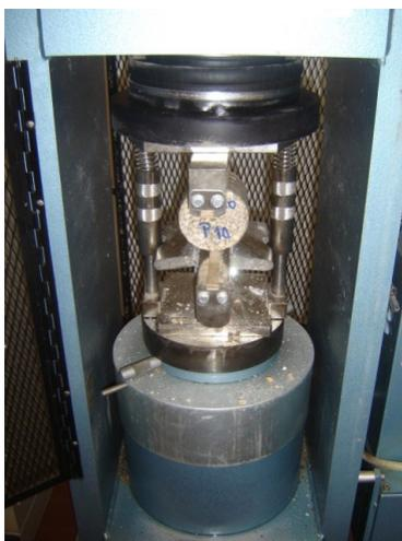
Figura 7.17 – Equipamento utilizado nos ensaios de tracção por compressão diametral.
