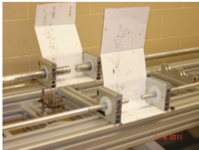
Figura 14. Extremidades das barras onde se intercala o provete.
