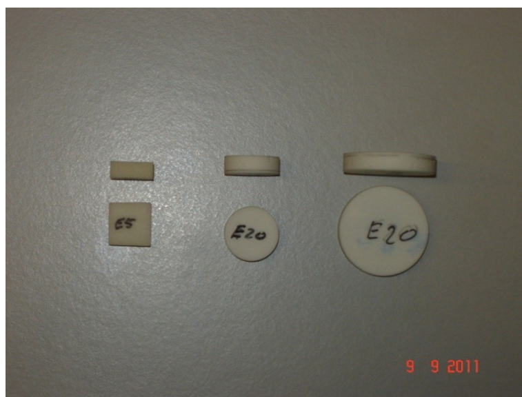
Figura 19. Imagem dos provetes utilizados nos ensaios experimentais. Provetes de secção quadrada com 11mm de lado e secção circular com 15 e 25 mm de diâmetro.
