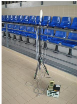
**Figura 42.** Analisador de climas interiores tipo 1213.
