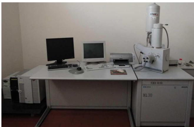
**Figura 28** Microscópio electrónico de varrimento Siemens XL 30
