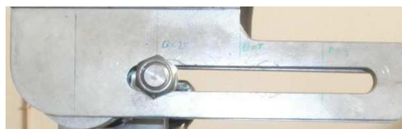
**Figura 23** Sistema que permite os rácios entre momento flector e torçor
