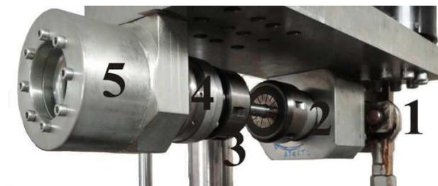
**Figura 25** Sistema para esforço de torção pura
