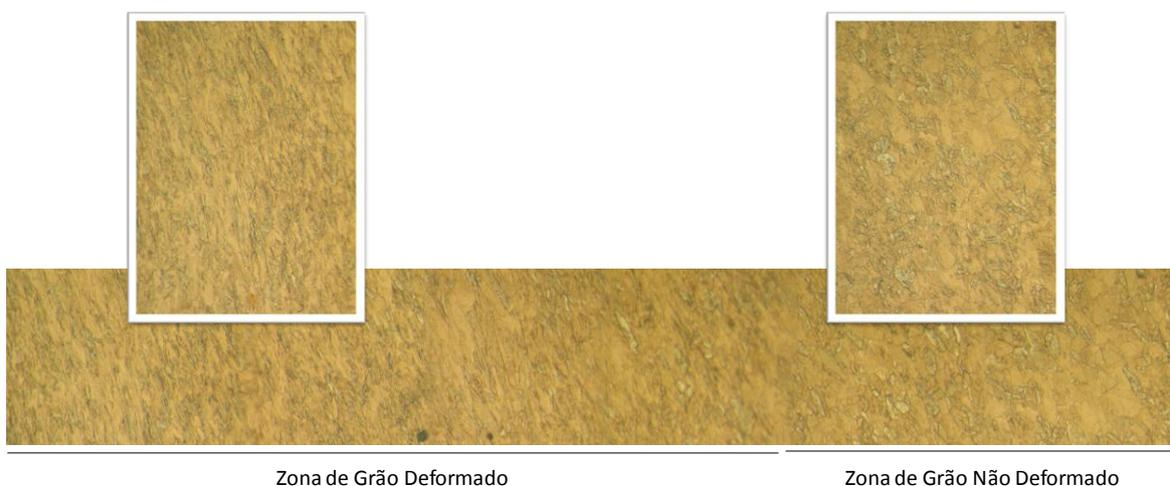
**Figura 44.** Perspectiva da microestrutura da amostra CU3 (ampliação 200x).
