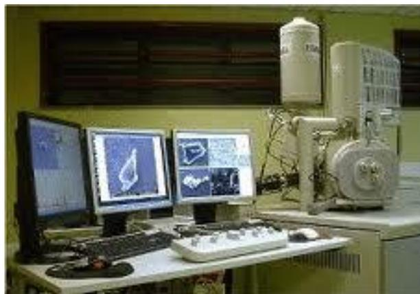
Figura 23. Microscópio electrónico de varrimento - CEMUP.
