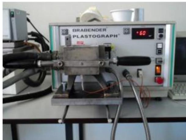
**Figura 6.** Misturadora utilizada para homogeneização dos nanotubos de carbono com o polímero revestido com cobre.
