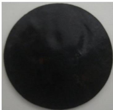
**Figura 14.** Disco de poliestireno revestido com cobre e adição de nanotubos obtido por prensagem.
