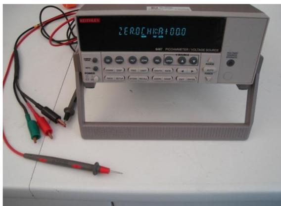
Figura 32. Picoamperímetro 6487 da marca KEITHLEY.
