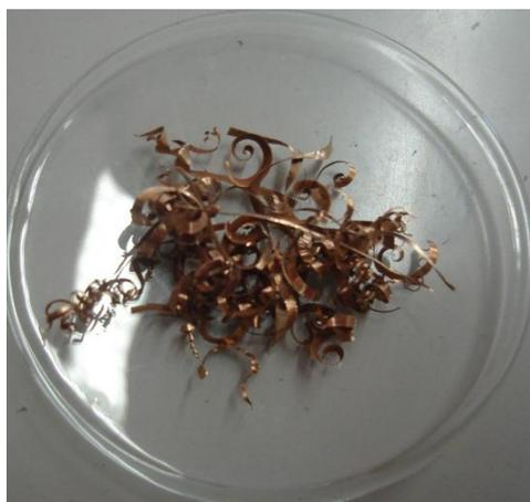
**Figura 40.** Amostra de aparas de cobre fornecidas pela indústria.
