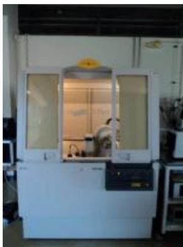
**Figura 41.** Difractómetro de Raio X.
