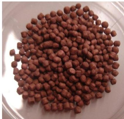
**Figura 13.** Poliestireno em grânulos revestidos com cobre.
