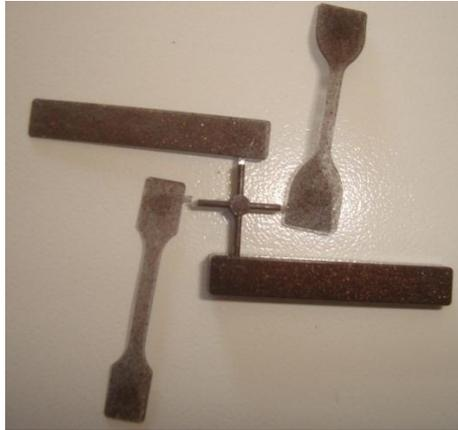
**Figura 11.** Provetes obtidos por microinjecção.
