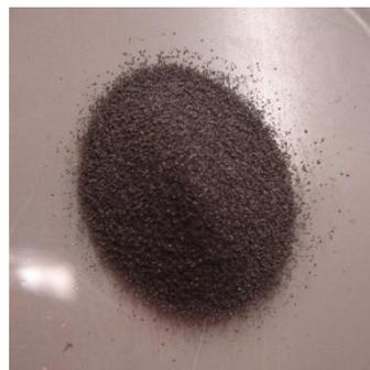
**Figura 12.** Poliestireno em pó revestido com aço.
