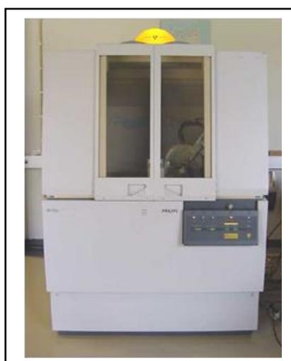
**Figura 2.6** - Difractómetro de raios X.
