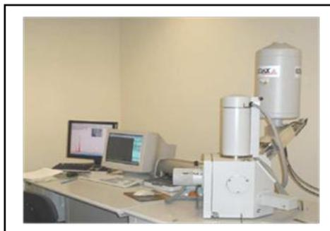
*Figura 2.8* - Equipamento de microscopia electrónica de varrimento.
