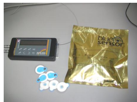
Figura 8: Eléctrodos descartáveis marca BLUE SENSOR®, modelo ECG ELECTRODES e sistema EMG da marca MEGA ELECTRONICS®, modelo MUSCLE TESTER ME 3000P4
