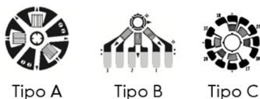
Figura 4.9: Tipos de roseta definidos na norma ASTM E837-08.[13]
