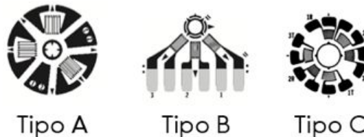
Figura 3.3: Os três tipos de rosetas normalizados pela ASTM E 837.[13]
