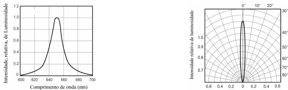
Figura IV.7 – Intensidade de luminosidade, do LED de emissão de vermelho (*TLDR5800*) em função do comprimento de onda (esq.) e do deslocamento angular (dir.).
