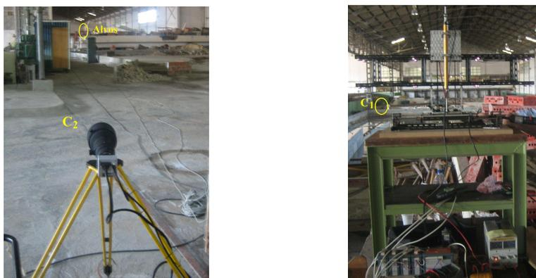
Figura 6.46 – Linha de vista da câmara  $C_2$  para o sistema de alvos (esq.). Imposição de movimento no sistema de alvos e linha de vista para a câmara  $C_1$  (dir.).
