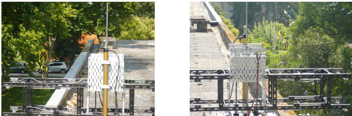
Figura 6.37 – Linha de vista do sistema de alvos para as câmaras  $C_1$  (esq.) e  $C_2$  (dir.).
