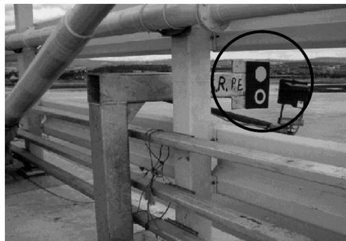
Figura 2.33 – Iluminação do alvo passivo por uma fonte de iluminação artificial (adaptado de Macdonald, 1997).
