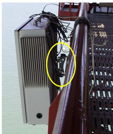
Figura III.14 – Dispositivo de fixação e de orientação do alvo.
