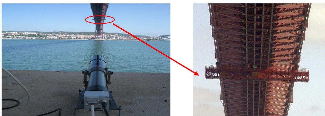
Figura III.12 – Subsistema de visão alinhado na direcção do alvo.
