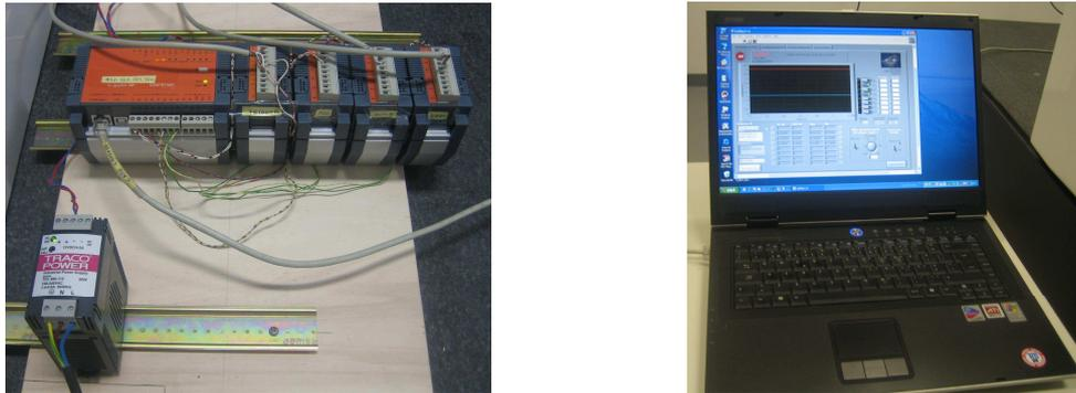
Figura 6.34 – Sistema de aquisição de dados, do sistema de medição de referência.
