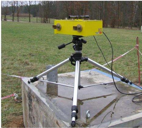
Figura 2.10 – Sistema de medição de deslocamentos IBIS-S, baseado na tecnologia de radar ([www.idsgeoradar.com](http://www.idsgeoradar.com)).
