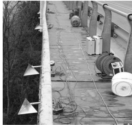
Figura 2.11 – Instalação de alvos passivos no tabuleiro da ponte Capriate, Itália (Bernardini, 2007-c).
