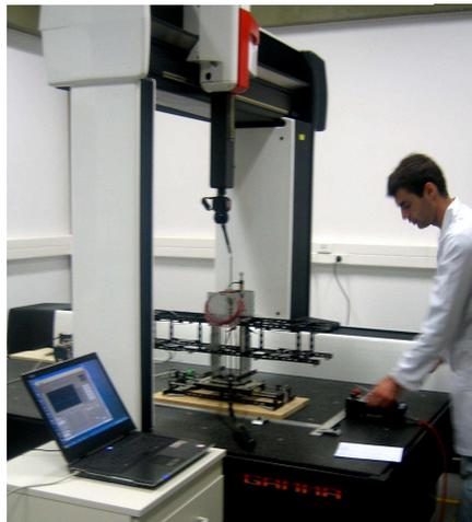
Figura 6.33 – Levantamento da posição 3D de cada um dos LEDs e calibração da cadeia de medição do sistema de referência, usando uma máquina de medição de coordenadas 3D, marca DEA (MMC3D) e modelo Gamma 22.03.
