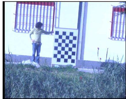
*Figura 3.10 – Imagem do painel de calibração (8x6 quadrados com 150 mm de lado), adquirida à distância aproximada de 400 m.*
