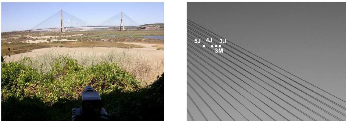
Figura 2.46 – Sistema de visão na posição de observação dos cabos de suspensão da Ponte do Guadiana (esq.) e imagem adquirida com indicação dos pontos analisados (dir.) (Silva, 2007-a).
