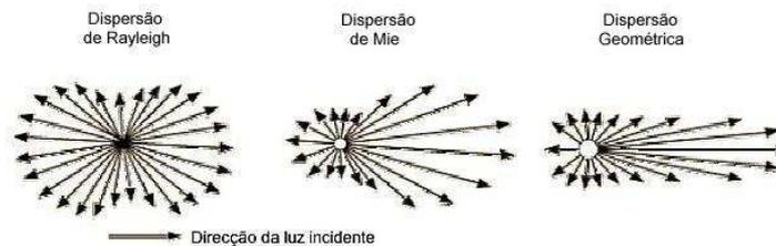
Figura I.8 – Representação esquemática dos diversos tipos de dispersão (adaptado de Casey, 2003).
