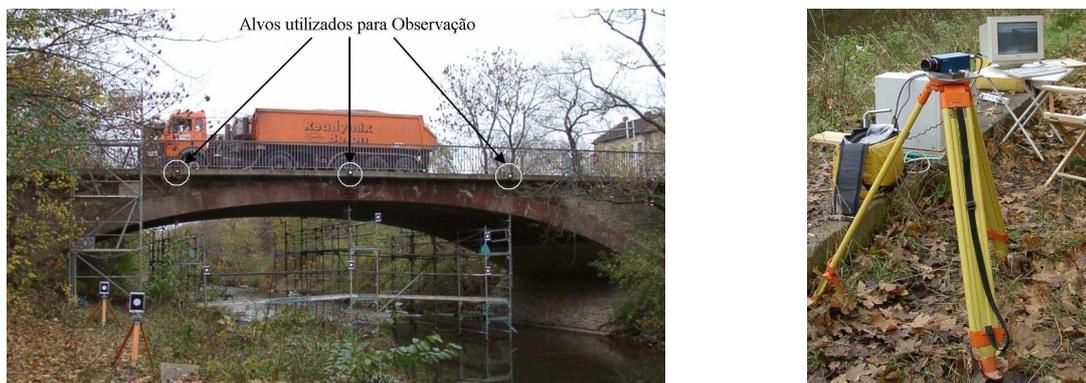
Figura 2.23 – Ensaio de carga de uma ponte. Sistema de visão usado para a aquisição das imagens (Albert, 2002).
