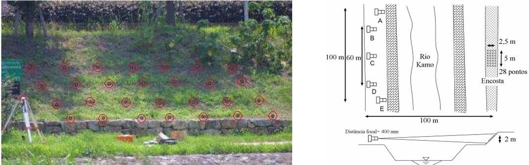
Figura 2.22 – Observação do deslizamento de uma encosta, situada a cerca de 100 m de distância do sistema de visão, fazendo uso de 28 alvos (adaptado de Ono, 2004).
