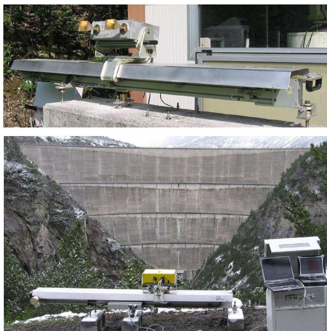
Figura 2.16 – Sistema *IBIS-L*, vocacionado para a medição de deformações ([www.idsgeoradar.com](http://www.idsgeoradar.com)).
