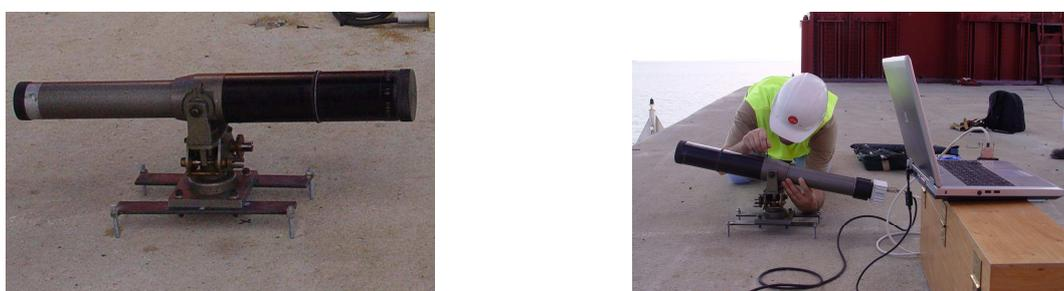
Figura III.13 – Posição do subsistema de visão no maciço superior da base do pilar P3 (esq.). Base de fixação e de nivelamento do subsistema de visão (dir.).
