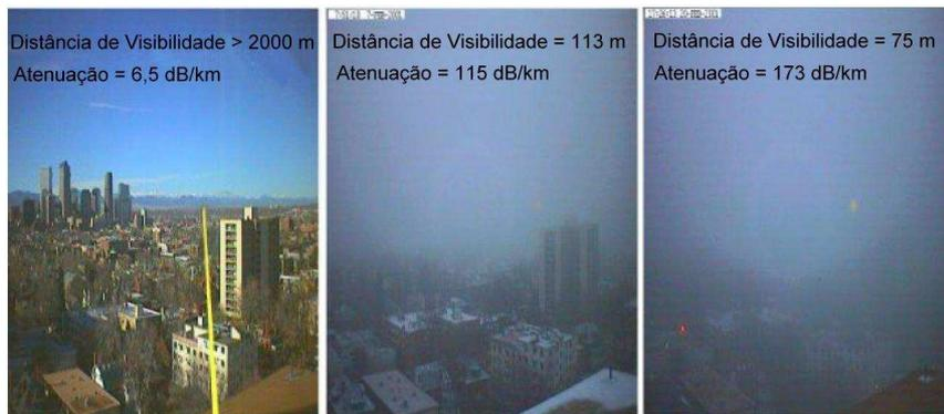
Figura I.6 – Três imagens da cidade de Denver, Colorado, relativas a três condições atmosféricas de visibilidade e respectivos valores de atenuação do sinal óptico (infravermelho próximo). A torre do edifício, situado à direita da imagem encontra-se a cerca de 300 m de distância e o ponto indicado pelo fim da linha a amarelo a cerca de 2,4 km (adaptado de Bloom, 2003).
