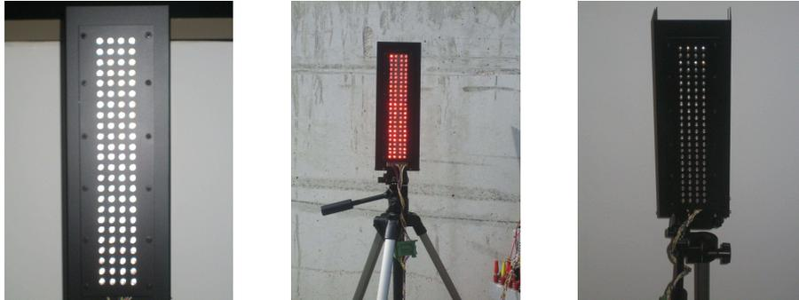
Figura IV.9 – Alvo de testes formado por quatro linhas de LEDs de emissão de radiação de vermelho (centro) e de infravermelho próximo (dir.), com espaçamento de 10 mm entre LEDs.
