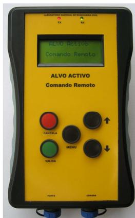
Figura III.10 – Consola portátil, com visor e teclado, para configurar o alvo.
