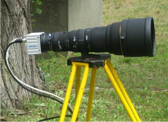
Figura 6.28 – Subsistema de visão empregue na realização dos ensaios com modelo físico.
