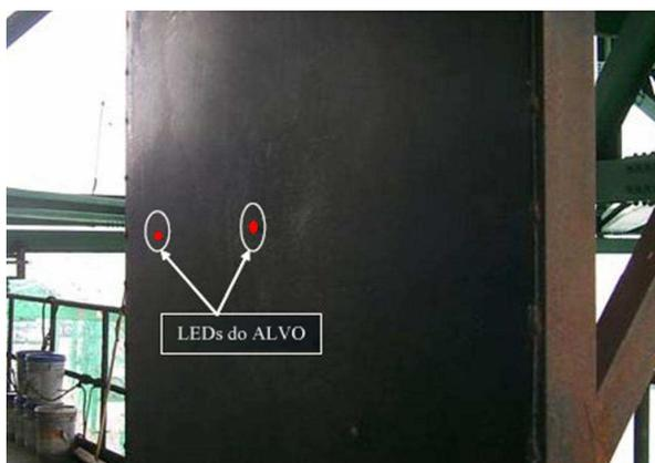
Figura 2.42 – Posicionamento do alvo, formado por dois LEDs, um dos quais usado, exclusivamente, para a realização da calibração do sistema de medição (Wahbeh, 2003).
