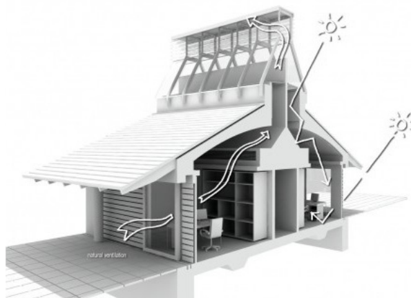
Figura 2.27 - Esquema de aspirador estático ( http://www.archdaily.com )
