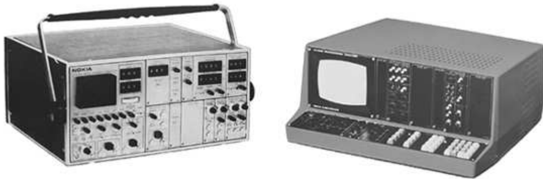
Figura 2.3: Analisadores Multicanal típicos da década de 70. Do lado esquerdo o exemplo de um MCA com 1600 canais e do lado direito a versão LP4900 de 4096 canais (1975). (Reproduzido de catálogo Nokia Electronics série LP4000.)
