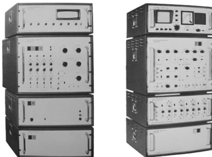
Figura 2.2: Exemplos de Analisadores Multicanal típicos da década de 60. Do lado esquerdo o LP4000 com 256 canais (1963) e do lado direito a versão LP4050 de 512 canais (1967). (Reproduzido de catálogo Nokia Electronics série LP4000.)
