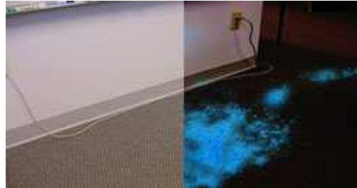
Figura 35: Aplicação de Luminol para detecção de vestígios hemáticos latentes.
