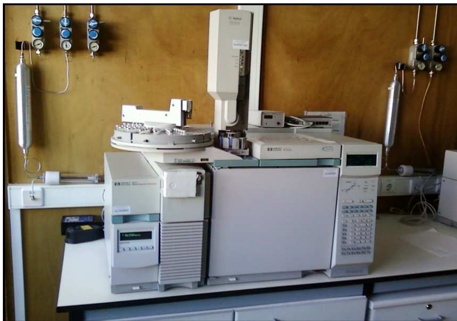
Figura 10 - Cromatógrafo de Gás acoplado a detector de Espectrometria de Massa
