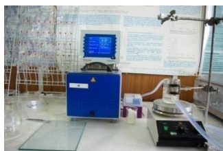
Figura 10: Montagem preparada para a realização de experiências de libertação de porfirina de géis de PVA.
