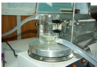
Figura 11: Recipiente utilizado nas experiências de liberação dos hidrogéis PVA-porfirina na mistura de solventes DMSO:H 2 O (5:100).
