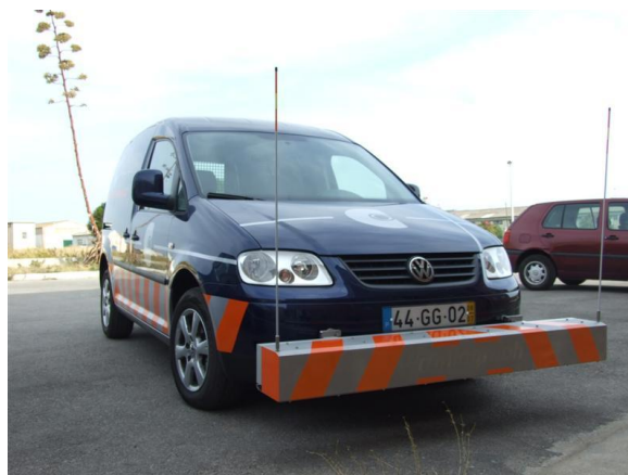
Figura 3.24 - Equipamento Laser utilizado para medição do Índice de Irregularidade Longitudinal (Consultrada, 2009-a)
