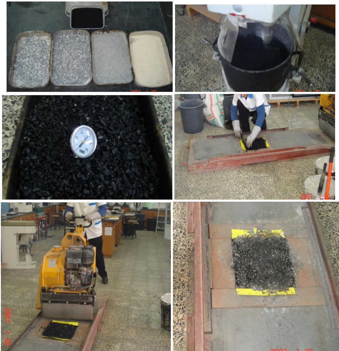
Figura 4.18 - Aspectos da produção e compactação de misturas em laboratório
