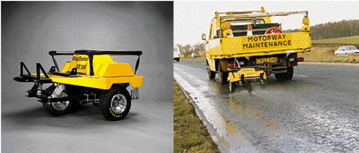
Figura 3.30 - Equipamento GripTester utilizado na medição do Coeficiente de Atrito (Mastrad, 2010)
