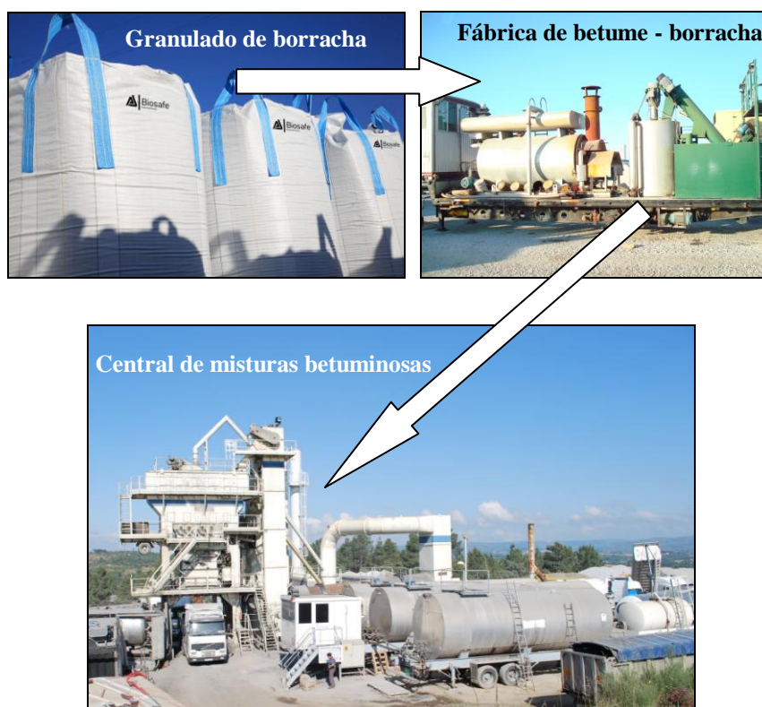
Figura 2.10 - Produção de misturas betuminosas com betume-borracha por via húmida
