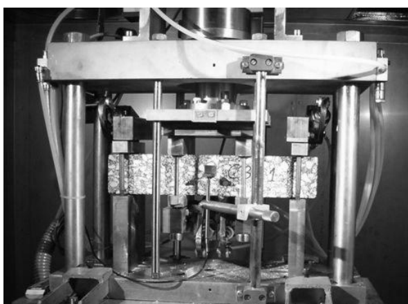
Figura 3.15 - Equipamento para realização de ensaios com aplicação de cargas repetidas (DEC-FCTUC) usado em ensaios de flexão em quatro pontos (Baptista, 2006)
