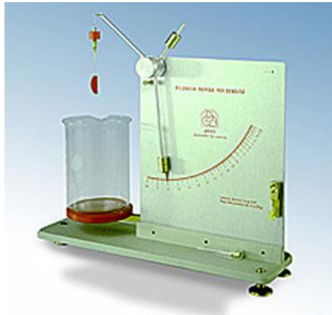
Figura 3.9 - Equipamento para determinação da massa específica da borracha (Gibrite, 2009)
