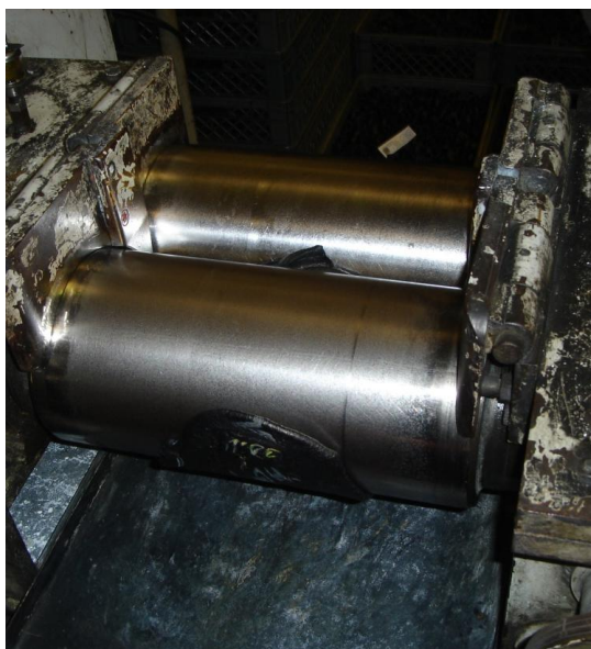
Figura 3.6 - Fabrico das amostras de borracha para ensaio
