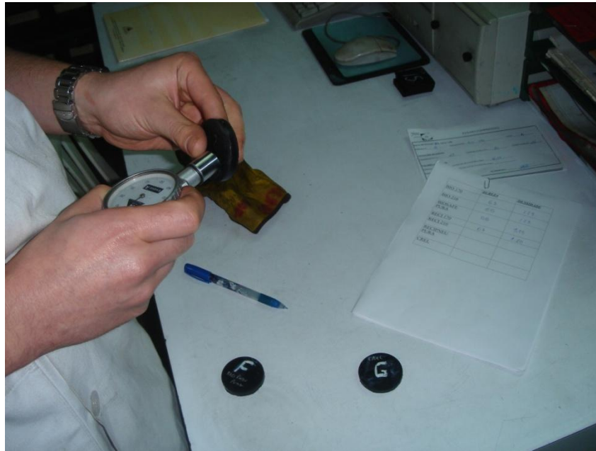
Figura 3.7 - Ensaio de dureza em provetes de borracha com durómetro de bolso
