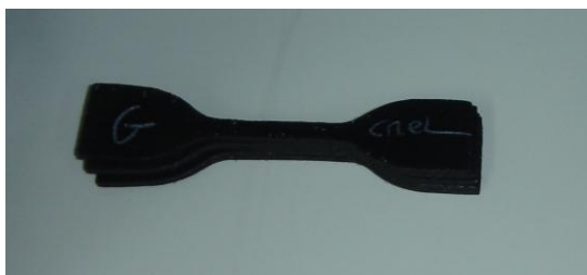
Figura 3.11 - Provetes em forma de halteres utilizados para a determinação da tensão-deformação em tracção
