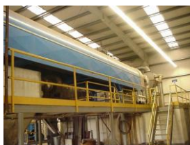
Fase 3: Entrada dos pedaços de borracha no túnel criogénico, encontrando-se o Moinho de martelos localizado no final do túnel criogénico
