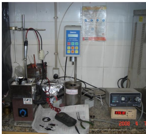
Figura 3.2 -Viscosímetro Brookfield utilizado para determinação da Viscosidade Rotacional
