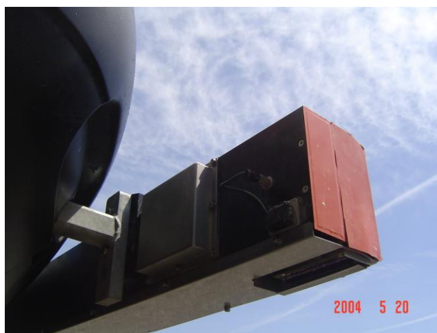
Figura 3.27 - Equipamento Texturómetro “LaserProf” Greenwood utilizado para medição da Macro-textura (Consulstrada, 2009a)
