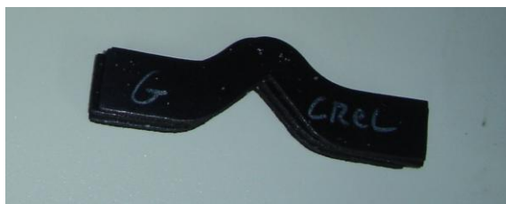
Figura 3.10 - Provetes em forma angular utilizados para determinação da resistência ao rasgamento
