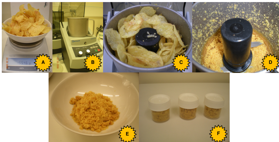
Figura 16. Principais etapas para a preparação da amostra. A – Pesagem das batatas fritas. B – Triturador Grindomix. C – Colocação das batatas fritas no copo de trituração. D – Amostra após a trituração. E – Homogeneização da amostra. F – Acondicionamento da amostra em frascos de plástico.
