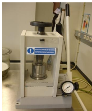
Figura 3.5 - Fotografia do sistema de prensagem. MiniPress , para a preparação de pastilhas a partir das amostras de pó fino.
