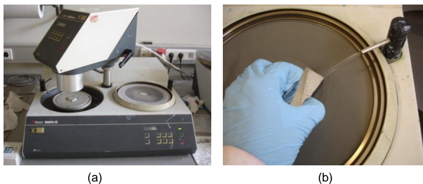
Figura 3.3 - Fotografias da polidora utilizada em laboratório, em diferentes perspectivas: (a) perspectiva geral, (b) no polimento de uma amostra.
