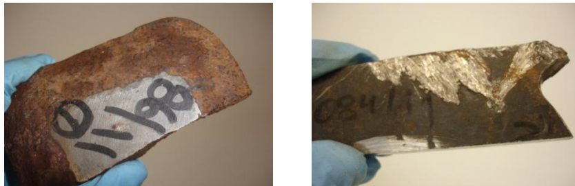
Figura 3.12 - Exemplos de amostras de ferro fundido, no estado bruto, provenientes da Fucoli - Somepal - Fundação de Ferro, S.A..
