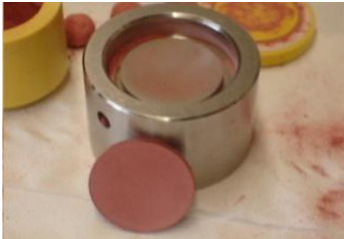
Figura 2.20 - Exemplo de uma pastilha de argila prensada em anéis de aço.
