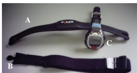
Figura 30. Tecnologia utilizada para a medição da frequência cardíaca. A) Banda transmissora, marca POLAR ® , modelo T81-CODED; B) cinto elástico, da marca polar, que permite ajustar a banda ao tórax do atleta; C) Cardiofrequencímetro, marca POLAR ® , modelo 810, série S.
