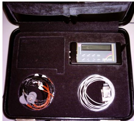
Figura 26. Sistema de registo electromiográfico MEGAWIN ® da MEGAELECTRONICS ® , com uma RRMC = 120 dB.
