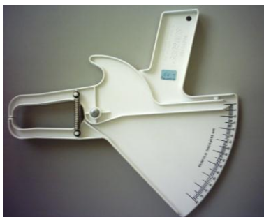
Figura 19. Adipómetro, marca SLIM GUIDE ® , com pressão constante de 10 g/mm 2 e precisão até às décimas de centímetro.
