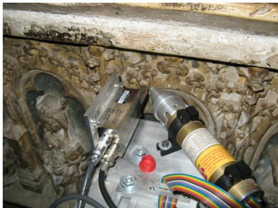
Figura 18: Aparelho de fluorescência de raios-X.
