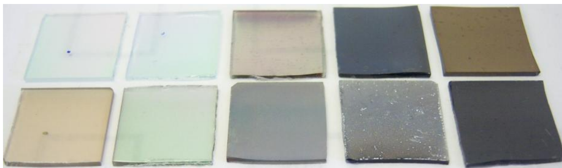
Figura 4.0.10: Amostra dos materiais a testar. TiO 2 , Ag 1 , Ag 2 , Ag 3 e Ag 4 em substrato vidro (esquerda para a direita em cima), em baixo o mesmo material após tratamento térmico.
