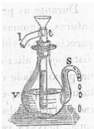
Figura 44 - Recipiente transformado por Santos e Silva para a extracção de essências orgânicas (Silva, 1874b, p. 211)
