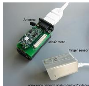
Figura 15. Aspecto do Sistema CodeBlue (sensor wireless oxímetro de pulso). [23]
