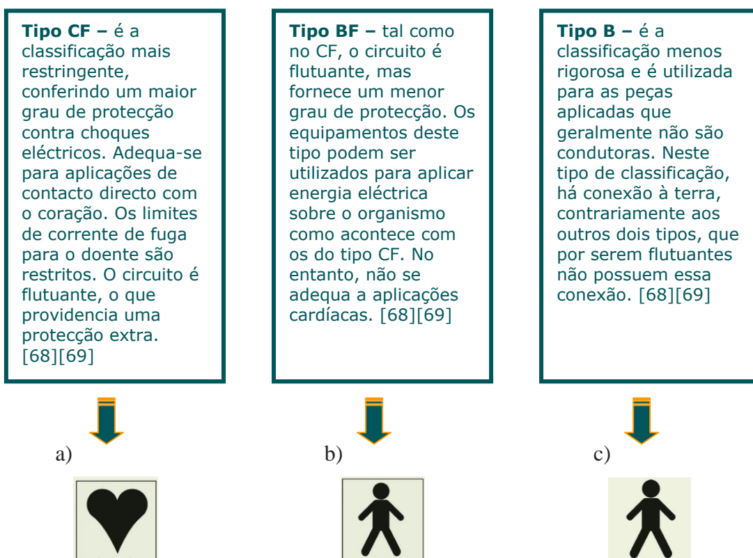
Figura 31. Símbolos representativos dos equipamentos pertencentes ao a) tipo CF, b) tipo BF e c) tipo B. [68]
