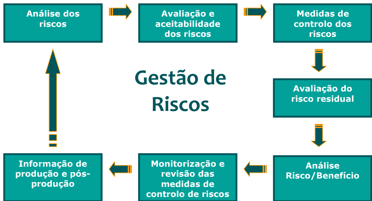
Figura 29. Esquematisação do processo de gestão de riscos. [65]
