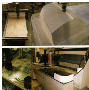
Fig.14..Fabrico Digital por Subtracção: Frezadora CNC (em cima) e corte por Jacto de Água (em baixo).
