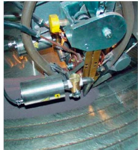
**Figura 2.4:** Deposição de revestimentos por soldadura de arco submerso [6].
