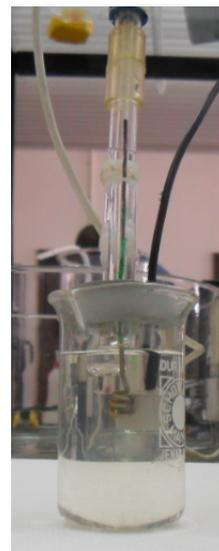
(b) Célula electroquímica de 3 eléctrodos, utilizada nos ensaios de corrosão.
