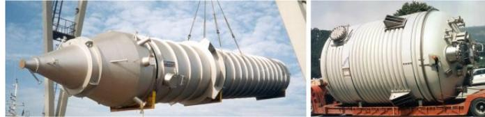
**Figura 2.2:** Exemplo de equipamentos de processo: reactores usados na indústria petroquímica [2].
