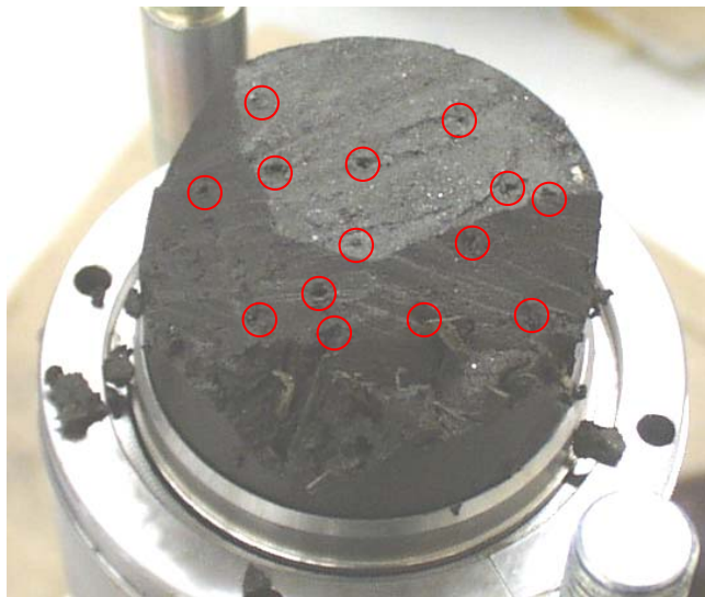
Figura 4.18 – Identificação de caminhos preferenciais de percolação (materializados por fibras vegetais) na amostra intacta AI 9 (colhida na direcção vertical).
