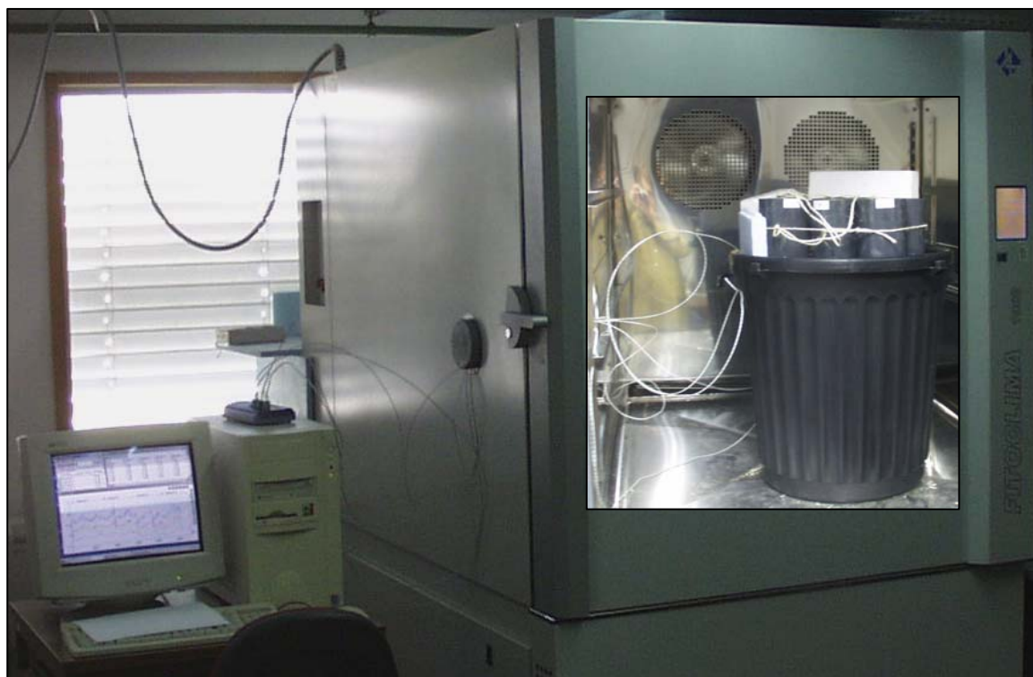
Figura 7.22 – Vista geral do equipamento para realização dos ensaios sob temperatura de 16 e 13°C, com pormenor da vista interior.
