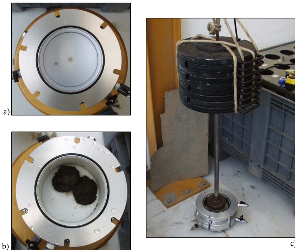
Figura 8.19 – Preparação de amostra de solo estabilizado na célula de Rowe: a) vista superior da célula; b) introdução da mistura; c) compactação.
