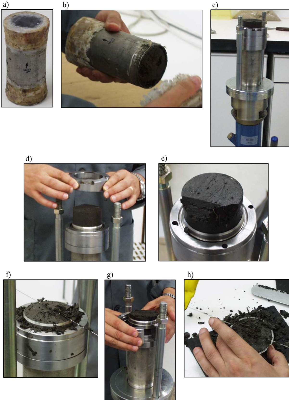
Figura 4.2 – Preparação de amostras provenientes de tubo amostrador para o ensaio edométrico - diferentes fases: a) a h).
