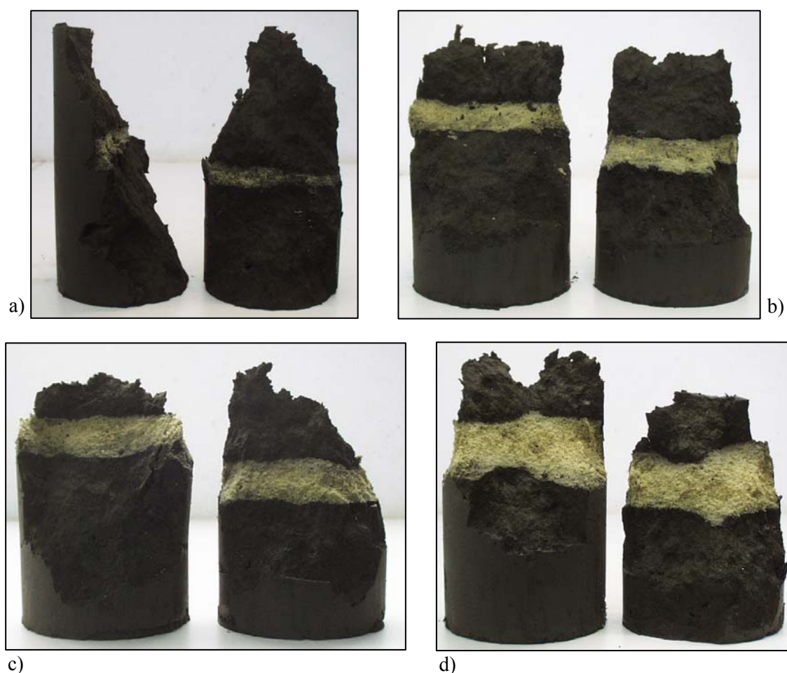
Figura 7.41 – Amostras estabilizadas com a inclusão de fina camada de areia localizada a meia altura, após a realização do ensaio UCS, com espessuras da camada de areia de: a) 10mm; b) 15mm; c) 20mm; d) 30mm.
