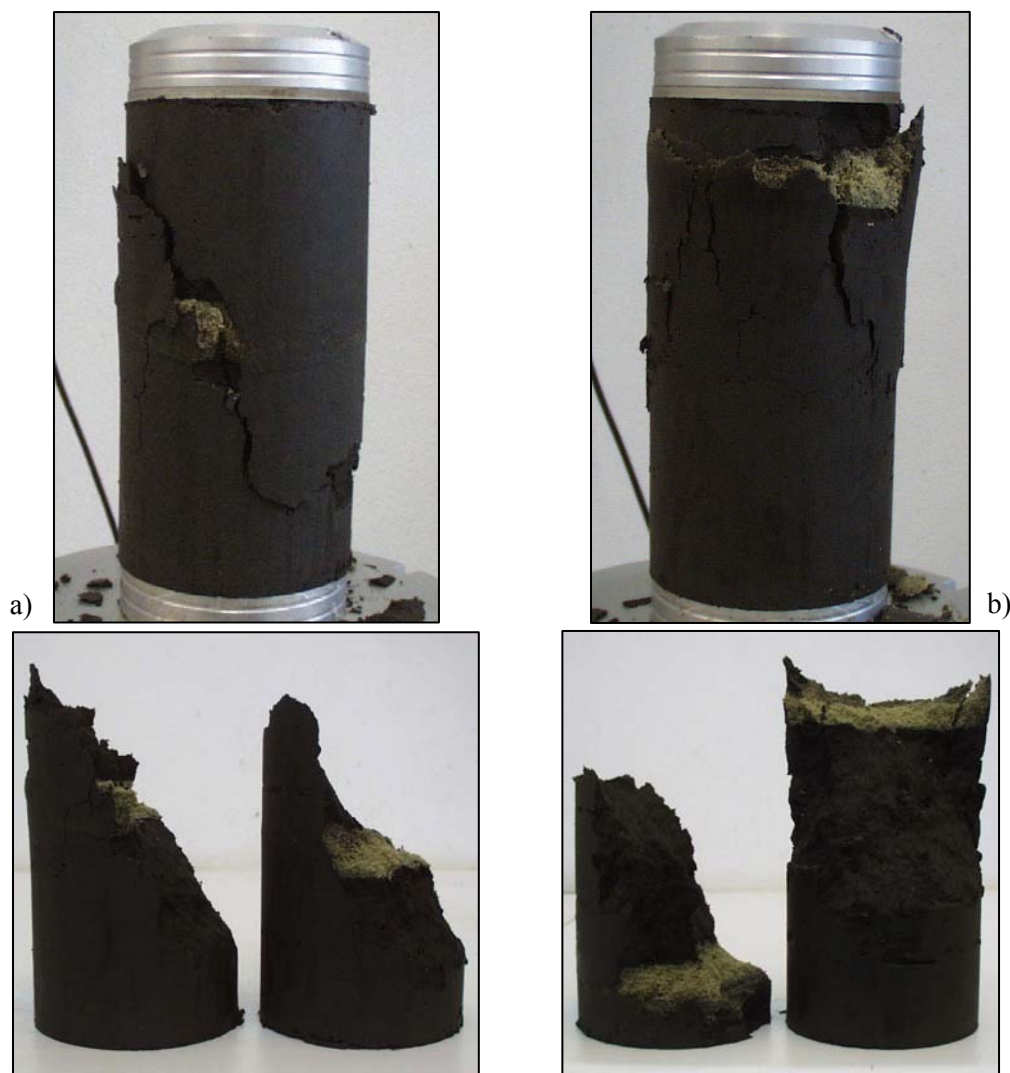
Figura 7.39 – Modo de rotura de amostras estabilizadas com a inclusão de fina camada de areia com 15mm de espessura e localizada: a) a meia altura; b) próxima do topo.
