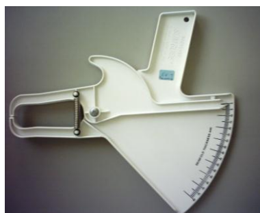
Figura 14. Adipómetro, marca SLIM GUIDE ® , com pressão constante de 10 g/mm 2 e precisão até às décimas de centímetro.
