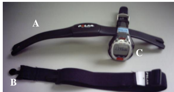
Figura 20. Tecnologia utilizada para a medição da frequência cardíaca. A) Banda transmissora, marca POLAR ® , modelo T81-CODED; B) cinto elástico, da marca polar, que permite ajustar a banda ao tórax do atleta; C) Cardiofrequencímetro, marca POLAR ® , modelo 810, série S.
