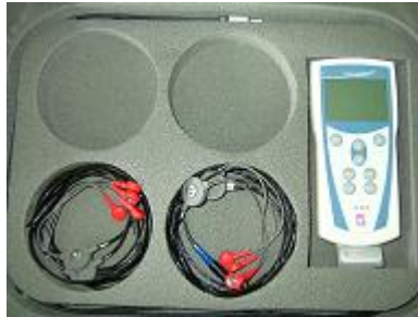
Figura 17. Sistema de registo electromiográfico MEGAWIN ® da MEGAELECTRONICS ® , modelo ME600 com uma RRMCM = 110 dB.
