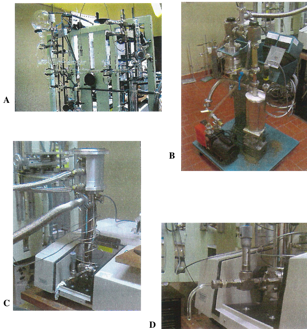
Fig.2.2.1 – Equipamento utilizado no Departamento de Química da Faculdade de Ciências e Tecnologia da Universidade de Coimbra: A – linha de vazio, B – sistema de bombagem, C – criostato e D – célula de Knudsen com dupla termostatização, constituída pela a válvula de agulheta e o recipiente da amostra.
