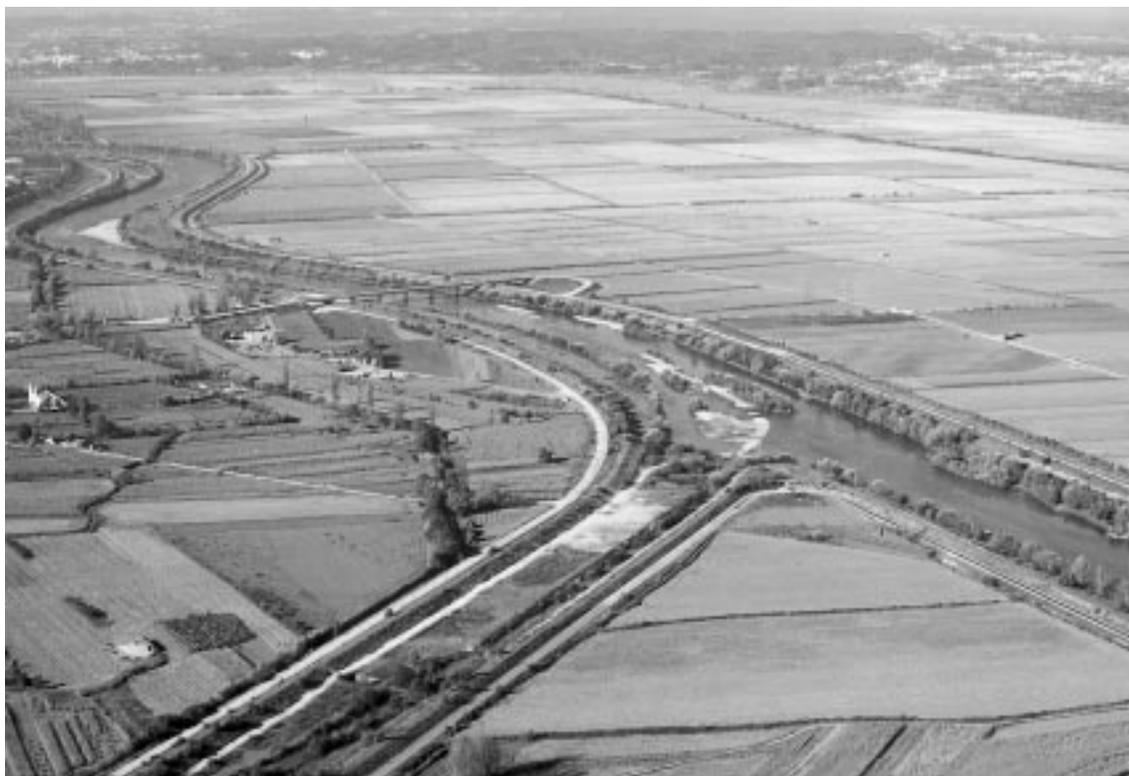
Foto 4 – Vista aérea oblíqua do Canal Principal do Mondego, entre a confluência com o Leito Periférico Esquerdo e o açude de Formoselha (foto de P. Cunha, a 6/11/1998). Notar as ilhas com árvores no local onde se fazia extracção de areia.
