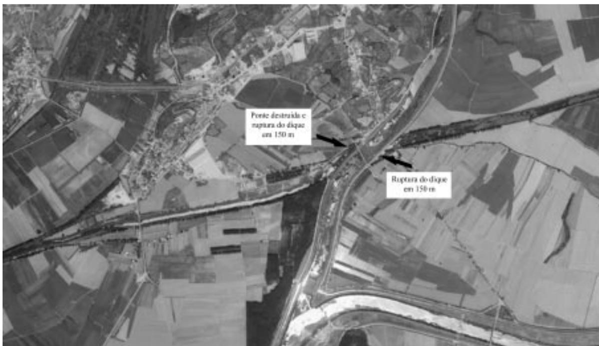
Foto 3 – Localização das rupturas nos diques do Leito Periférico Direito, em Montemor-o-Velho (adap. a partir de ortofoto do CNIG, 1995).
