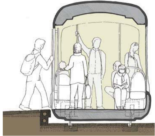
[67] Com um piso cem por cento rebaixado, o veículo de metro facilita a acessibilidade deste sistema de transporte
