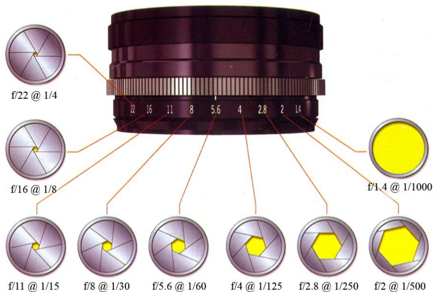
Fig. 6: Representação de como a abertura do diafragma e a velocidade do obturador se comportariam em um mesmo cenário.
