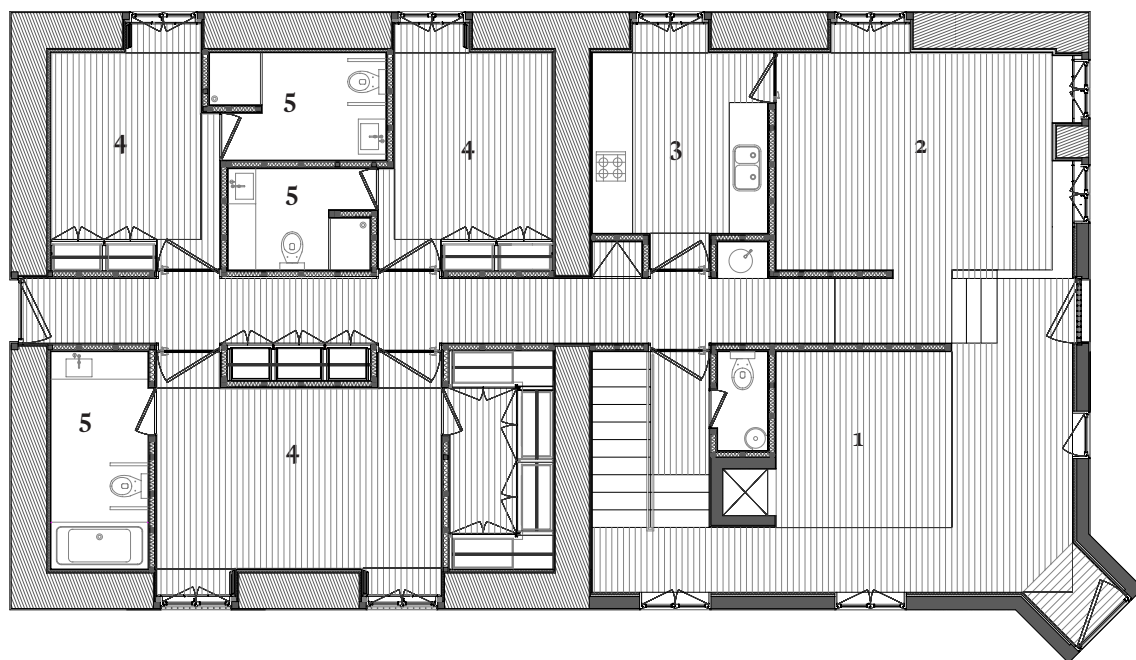
01 Sala 02 Sala Jantar 03 Cozinha 04 Quarto 05 Instalação sanitária
