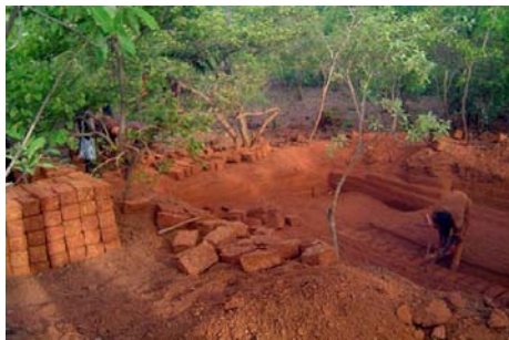
Fig. 30 - Extração e corte dos tijolos.
