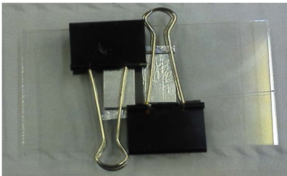
Figura 31. Pormenor do conjunto colocado na estufa a 120° C para proceder ao rejuvenescimento das amostras.
