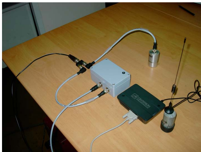
Figura 36 - Módulo TC65T Cinterion, o sensor EWS TA3T-c, e a gateway EWS GR, com os primeiros dois ligados por CAN, e os últimos dois por RS232.
