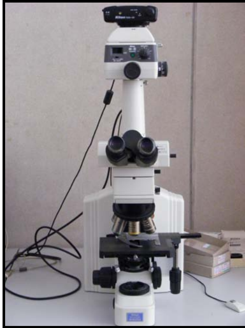
Figura 31 - Microscópio Nikon Eclipse E600, utilizado para visualização dos cortes dos dentes.
