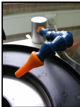
Figura 25 - Mangueira que permite o contínuo direccionamento do jacto de água para cima da lâmina de corte.
