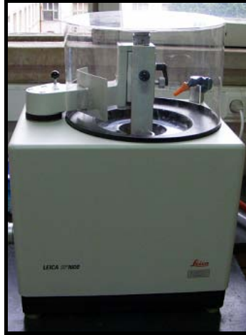
Figura 21 - Micrótomoto de tecidos duros utilizado, modelo Leitz 1600, da Leica.
