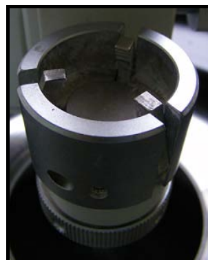
Figura 22 - Garras do micrótomoto que permitem a prensão do objecto a ser cortado.
