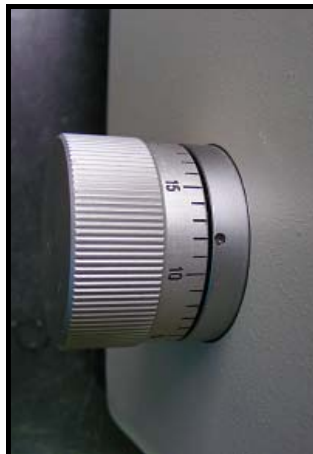
Figura 28 - Botão de controlo da velocidade de corte.
