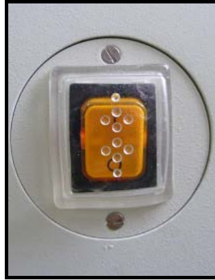
Figura 26 - Botão que permite ligar e desligar o micrótomo.
