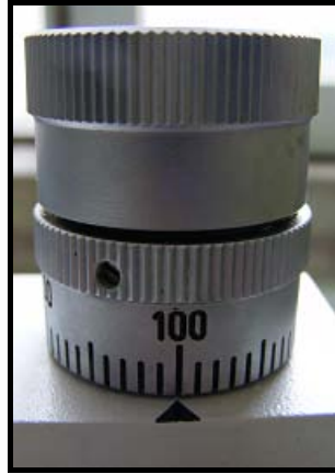
Figura 23 - Botão que permite escolher a espessura dos cortes a realizar.
