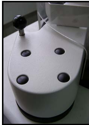
Figura 24 - Manipulo que permite destravar o micrótomo.
