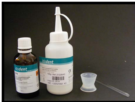
Figura 19 - Material utilizado para a inclusão dos dentes: os dois componentes do acrílico, a taça de silicone e a vareta de vidro.
