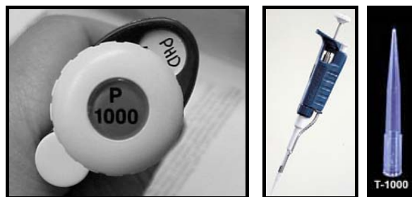
Figura 17 - Micropipeta Gilson pipetman P1000 e pontas de 1000 µl.
