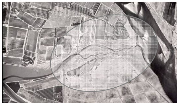
Figura 2 – Assoreamento no trecho montante do braço sul do estuário do Mondego
