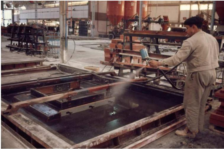
Fig.114 Lubrificação do fundo do molde de modo a facilitar desmoldagem.
