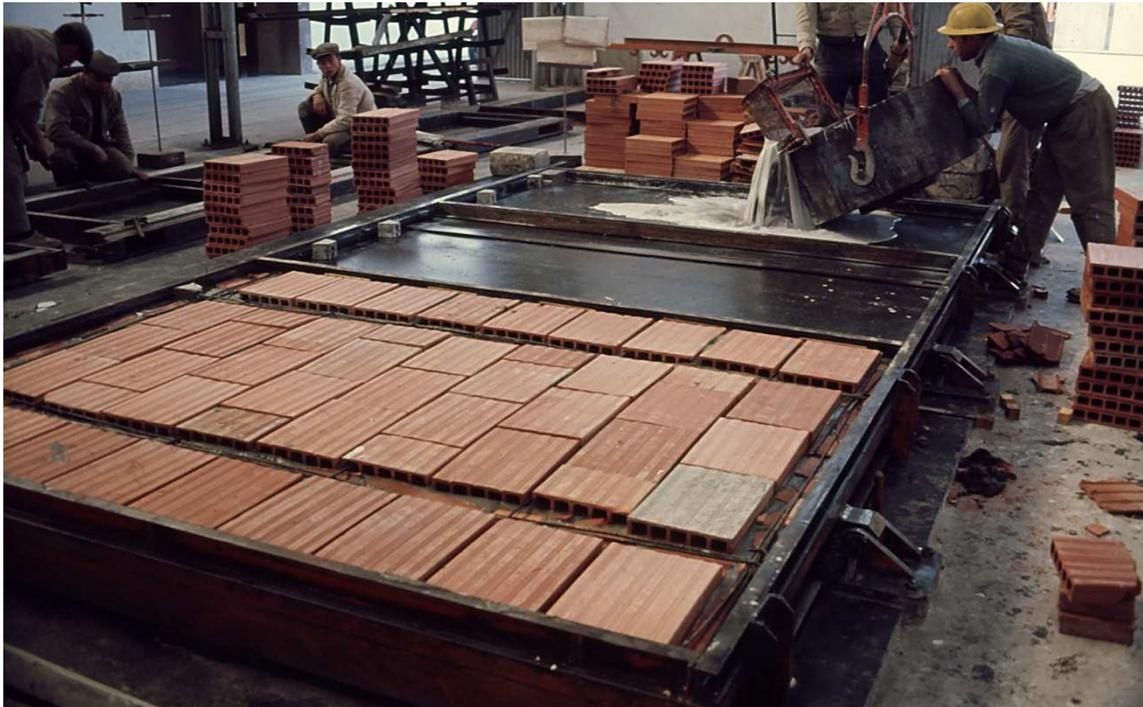
Fig.107 Pré-fabricação de tabique.
