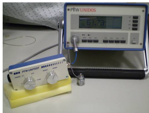
Figura 22. UNITEST (PTW – Freiburg) para verificar a consistência dos valores medidos pelo UNIDOS, nas diferentes escalas e modos de operação.
