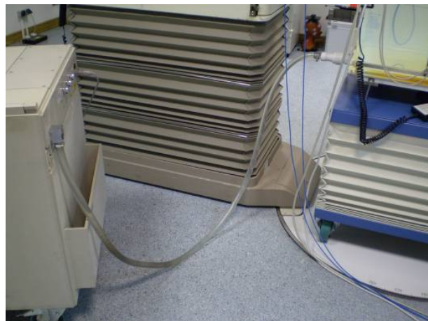
Figura 25. Ligação do reservatório de água ao fantoma, através de uma mangueira de plástico.
