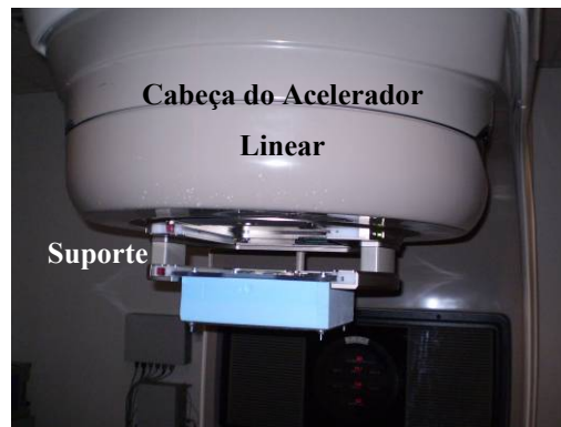
Figura 9. Filtro compensador colocado, no suporte, na cabeça do acelerador linear.
