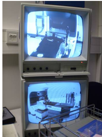
Figura 33. Monitores ligados à câmara de vigilância que permitem a visualização do interior do bunker .
