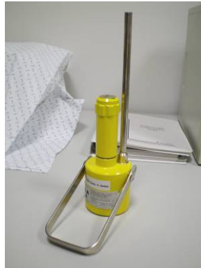
Figura 21. Padrão de Estrôncio – 90 (PTW – Freiburg).
