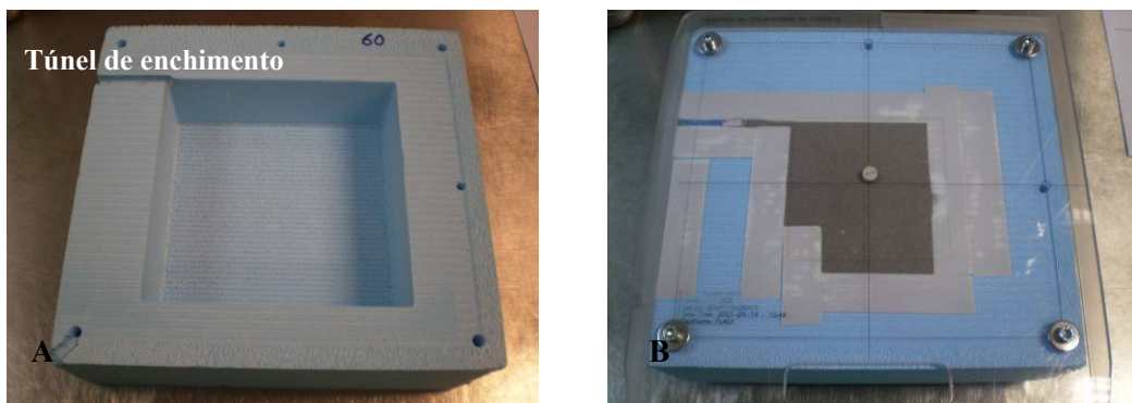
Figura 8. (A) Espuma e túnel de enchimento escavados; (B) Filtro compensador com o referido túnel por onde se realizou o enchimento.
