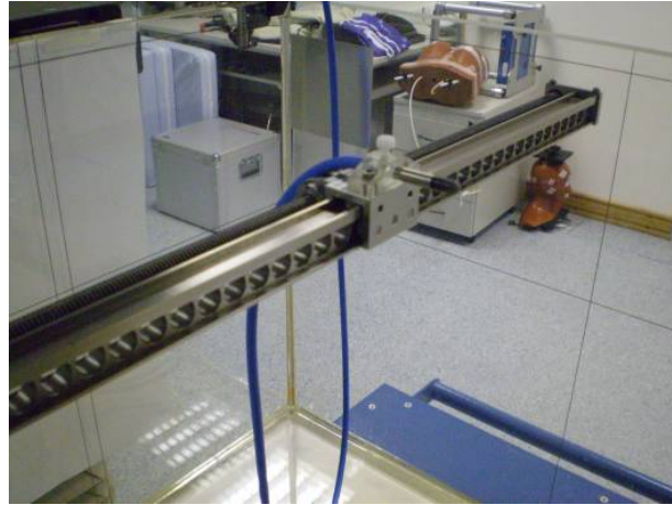
Figura 24. Câmara de ionização (câmara de campo) colocada no suporte do braço C.
