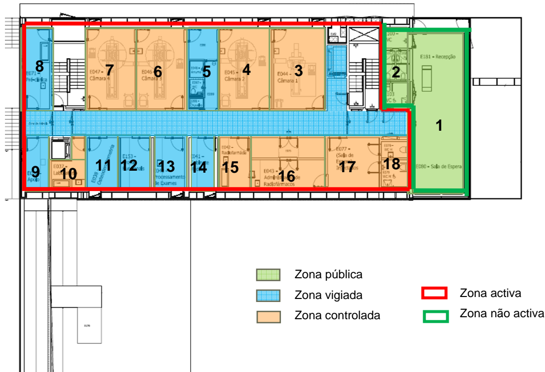
Figura 21: Planta do piso 0.
