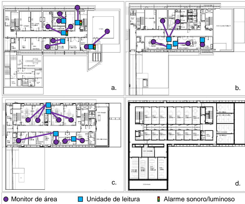
Figura 23: Representação esquemática da localização dos monitores de área e respectivas unidades de leitura e alarme no: a. piso -2; b. piso -1; c. piso 0 e d. piso 1.
