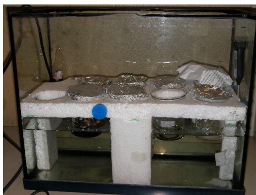
Figura 5.1: Foto dos aquários em que se obtém um banho térmico.
